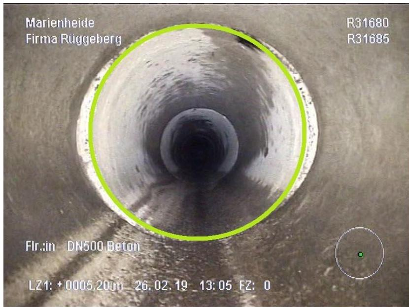
**Abbildung 2: Verformung der Haltung R31680**
